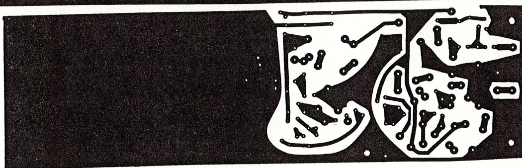
OSCILLATOR PCB DESIGN Actual Size Fig. B
